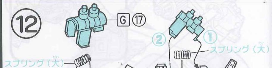
G17のバーツを取り付ける時は、後部を先に差し込んでから前部を取り付けます。(①～②の順に取り付けます。)
